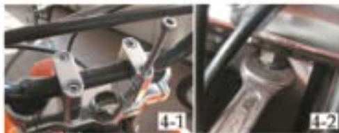
4. Använd ③ och ④ för att fästa styret
