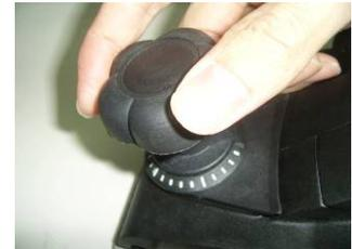
**OBSERVERA:** Säkerställ att siffran på ringen är i läge "0" när verktyget inte används. I detta läge kan kniven inte skära i arbetsstycket.
